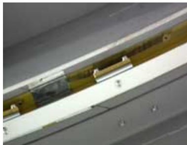
转动部位为独特刷式结构，具有与反射地面良好的导电性和电磁屏蔽性能。
