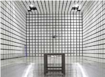
装置收纳时的电波暗室内部(10m法电波暗室)
